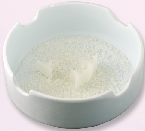
Ofendekontamination: Reste von nicht eingefärbtem, hochtranslucentem Zirkonoxid in einer Sinterschale auf Sinterperlen platziert.
