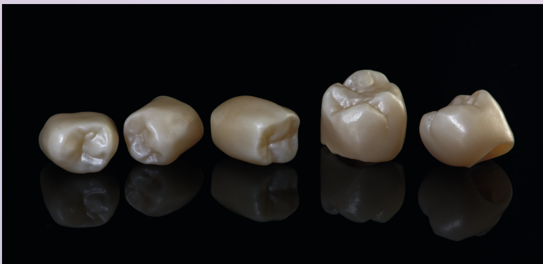
Zirkonoxid-Kronen mit ausgeprägter Opazität, insbesondere im typischerweise transluzenten Schmelzbereich.
