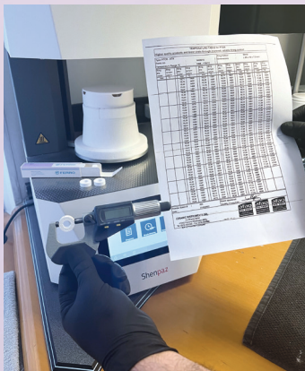
Ofenkalibrierung mit PTC-Ring, digitalem Messschieber und Temperaturliste.
