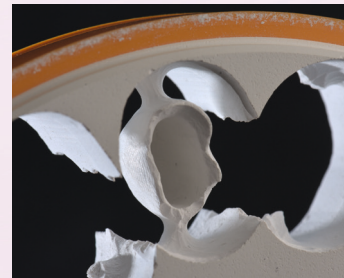
Beschädigte Restauration bei Entnahme aus dem Fräsgerät.
