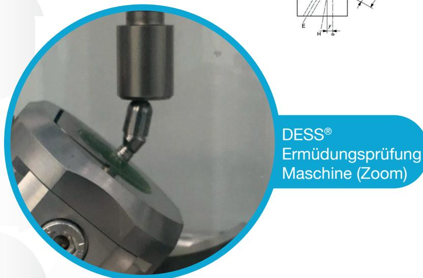
DESS® Ermüdungsprüfung Maschine (Zoom)
