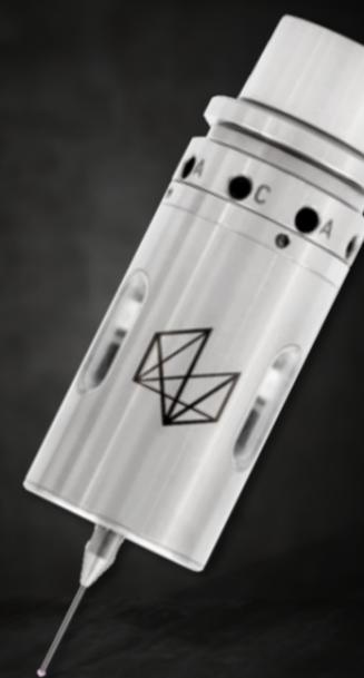
Mit dem 3D-Taster erfolgt über Referenzpunkte eine kontrollierte Vermessung, um Abweichungen, Verschiebungen und Verdrehungen festzustellen. Im Hintergrund verrechnet die imes-icore® 3D-Vermessungssoftware die Werte und schreibt diese in die CAM-Software zurück, um die Korrekturen umzusetzen.
