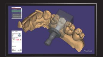
Mithilfe der exocad ChairsideCAD lassen sich Kronen, Inlays, Onlays, Veneers und kleine Brücken in einem sehr innovativen und schnellen Workflow direkt am Behandlungsplatz gestalten und fertigen. Über das integrierte In-CAD-Nesting Modul können die designten Jobs direkt im zu fräsendem Block platziert und für die Maschine berechnet werden.
