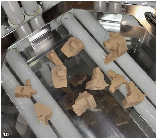
Abb. 10 Der frisch gedruckte Zahnkranz. Abb. 11 Der Zahnkranz auf der Baumann-Platte.
