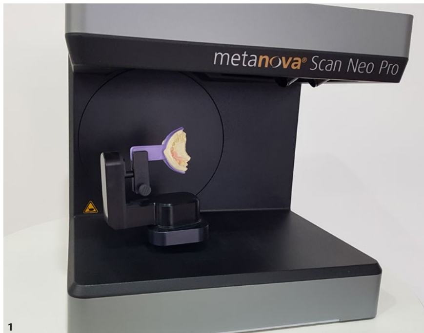
Abb. 1 Die Scanzeit für einen Kiefer beträgt im Metanova Scan Neo Pro nur zwölf Sekunden. Abb. 2 Der 3-D-Drucker NextDent 5100.
