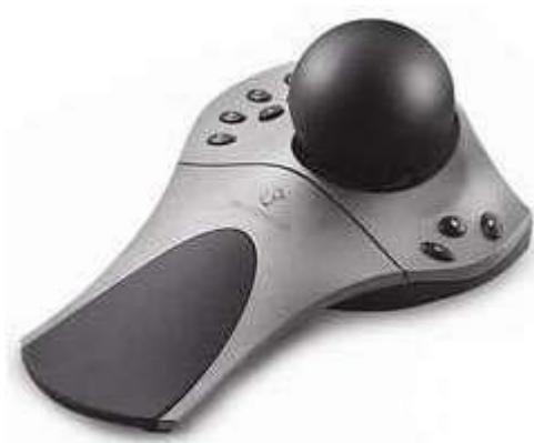
Beim Spaceball handelt es sich um einen Bewegungscontroller, der zusammen mit der Maus funktioniert und es ermöglicht, schnell durch die 3D-Bilder zu navigieren. Das Gerät umfasst eine Steuerkugel und programmierbare Schaltflächen.
