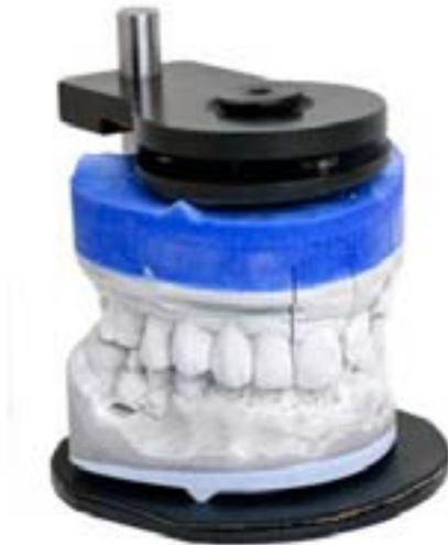
Hierzu muss der Benutzer beide Bögen auf eine speziell hierfür gefertigte Befestigungsvorrichtung montieren, wobei sich der Präparationsbogen unter dem Gegenbiss befinden und die Vorderseite der Zähne vom Metallsteg der Befestigungsvorrichtung weg zeigen muss (siehe Abbildung links).
